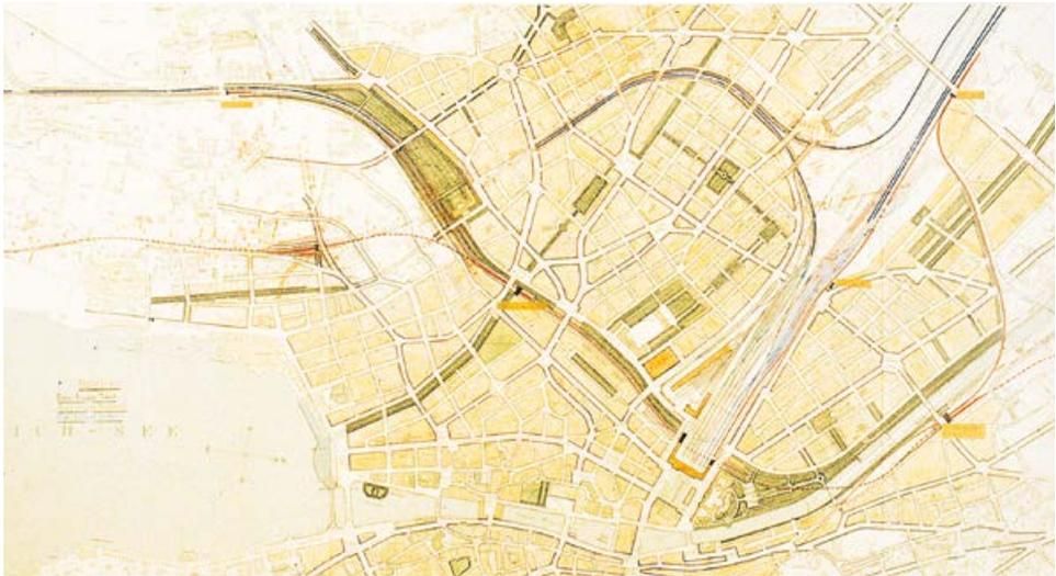
Die Neuorganisation der Bahn im Entwurf von Bodmer & Hippenmeier. Das trockenengelegte Sihlbett wird zum S-Bahntrasse. Dies ermöglicht schnelle Durchmesserlinien von Thalwil nach Oerlikon und ins Limmattal, mit Umsteigebahnhof im Letten. Sihlbett und Schanzengraben werden in Grünzüge umgewandelt. Entlang den Nebenstrassen wird eine Grünverbindung durch Aussersihl geschaffen. (BAZ)
